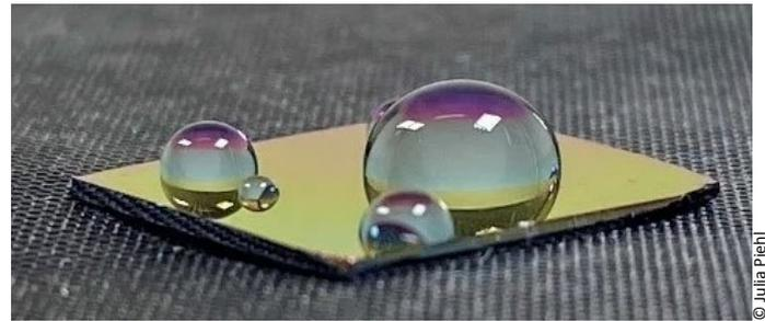
Mit speziellen iCVD-Beschichtungen werden Oberflächen zum Beispiel wasserabweisend.
